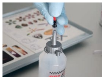
13. Монтирайте три тръбички в следния ред: 1. Прозрачна, 2. Черна, 3. Червена. Започнете апликирането.
