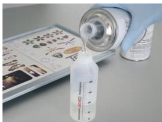
6. Дозирайте еднакво количество от двете течности/първо смолата, като използвате точна везна.
