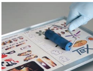
3. Притиснете принтовете с ролер, за да избегнете надигане на краищата.
