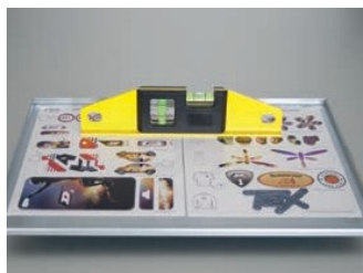
1. Поставете фолиото на плоска повърхност, използвайте спрей/лепяща лента за леко фиксирание. Нивелирайте основата.
