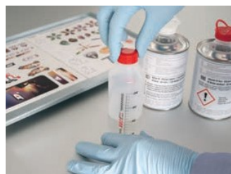
9. Отворете варио-дозата на диспенсъра.
